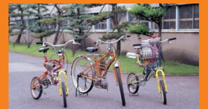
歴代のパワーアシスト自転車。左からジェットエンジン、蒸気機関、ペットボトルロケットを使った自転車。
