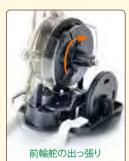
矢印の方向ばカチン」と音 がするまで回転させる。1回 がカチン」 につき、初めに お辞儀するまでの距離が約 2.5cmほど短くなる。
