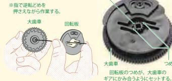
4 下図のようにゼンマイ軸を通して、右側板の穴にさす。
