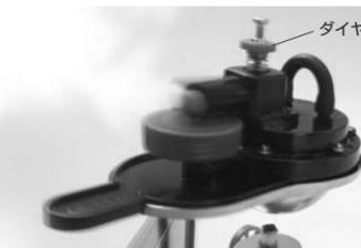
⑦ ランプの芯が焦げ始めたら火を消して止めよう(空だきに十分注意する)。消火は、金属のスプーンなど(アルミホイルで作ってもいい)をいったん水に濡らし、アルコールランプの芯に押し付けるようにしてかぶせる。
