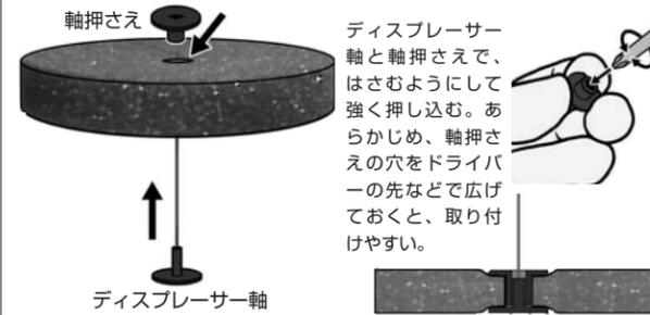
ディスプレイサー軸と軸押さえで、はさむようにして強く押し込む。あらかじめ、軸押さえの穴をドライバーの先などで広げておくと、取り付けやすい。
