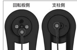
19 14で作ったディスプレイサーを軸受けパイプに通し、ディスプレイサーの軸とプッシュロッドをパイプでつなぐ。
